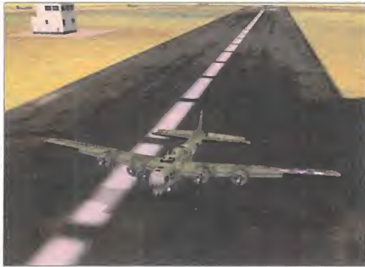
A plena carga, los B-17 necesitaban una pista muy larga para despegar; aún así, las gigantescas alas del avión le permitían poder alzar el vuelo transportando una gran carga bélica y a tope de combustible.
